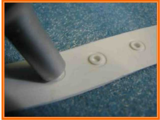
Ultrasonic kaynak örneği (iki plastik bantın (1.2 mm) kaynak örneğidir...)
